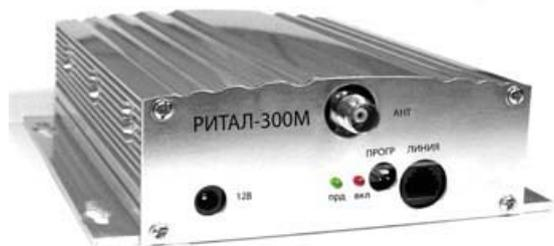
Нельзя включать в сеть 220В радиоудлиннитель без нагрузки (антенны)! Сначала подключаем к базовому и абонентскому блокам кабеля с антенной, затем, после того как все собрано подаем питание! Все отключения производятся в обратном порядке, сначала отключаем питание, потом отсоединяем антенны от блоков.
